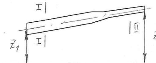
2. Задача. Определить расход воды в трубе  $D=300$  мм, если диаметр цилиндрической вставки Водомера Вентури  $d=200$  мм, разность напоров в большом и малом сечениях  $h=0,5$  м и коэффициент  $\zeta=0,98$ .
