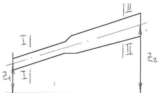
2. Задача. Определить среднюю скорость и расход жидкости в сечении меньшего диаметра конической трубы, если  $d_1=500$ ,  $d_2=300$  и средняя скорость в сечении большего диаметра  $\omega_1=0,5$  м\с.
