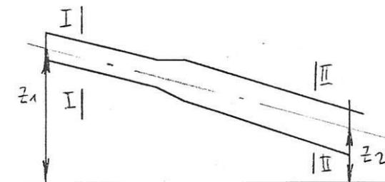
2. Задача. Определить расход воды в трубе  $D=400$  мм, если диаметр цилиндрической вставки Водомера Вентури  $d=350$  мм, разность напоров в большом и малом сечениях  $h=0,4$  м.  $\zeta=0,98$ .
