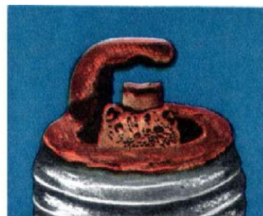
б - изношенная свеча
