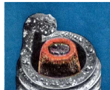
е - свеча, поврежденная ранним зажиганием
