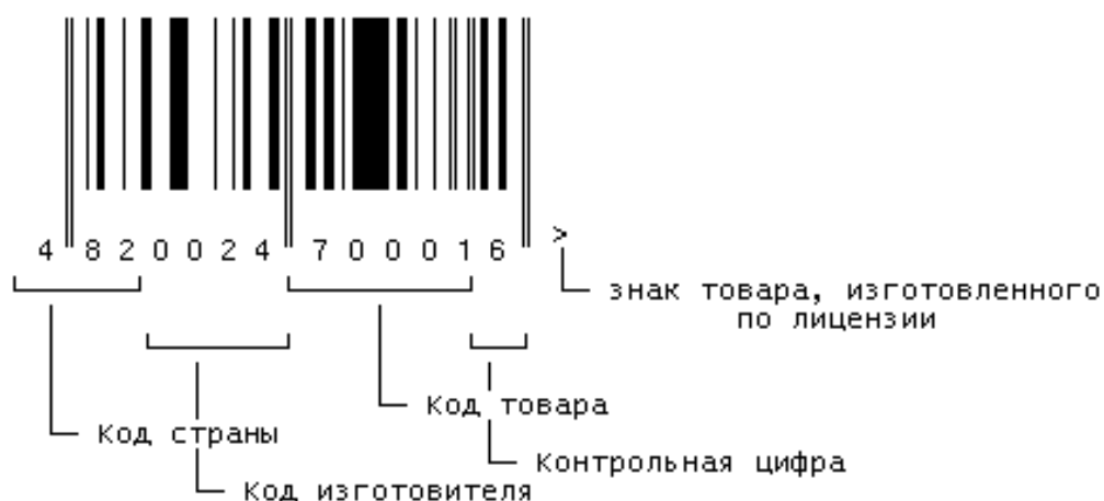
Рисунок 3 - Пример расшифровки штрих-кода EAN-13
