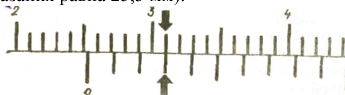
Рисунок 1.2 - Показания штангенциркуля 25,3 мм
