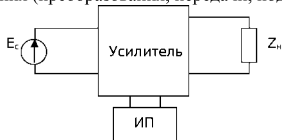
Рисунок 1.1 – Структурная схема усилителя
