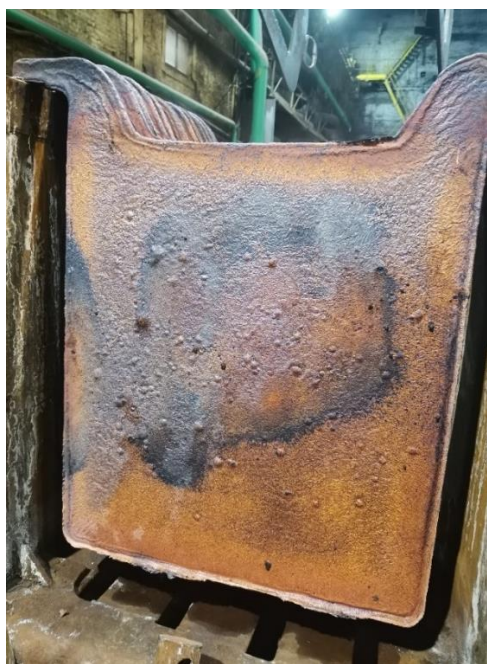
Рис. 4. Медный анод, отлитый с использованием покрытия «Литоформ» марки 900
