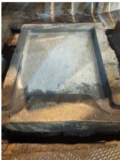
Рис. 1. Изложница с покрытием на основе шамотного мертеля
