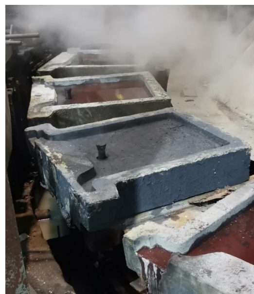
Рис. 3. Изложницы, обработанные суспензией противопопригарного покрытия «Литоформ» марки 900
