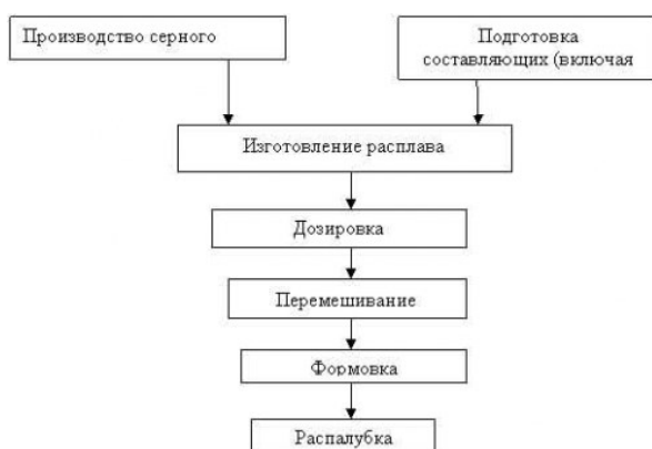
Рис. 2. Технологическая схема изготовления из серобетона конструкций
