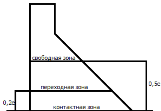
Рис. 4. Зоны термонапряженного состояния; e – наибольший плановый размер блока
