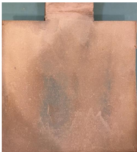
Рис. 4. Катод, при получении которого концентрация тиомочевина в электролите составляла 0 \text{ г/дм}^3
