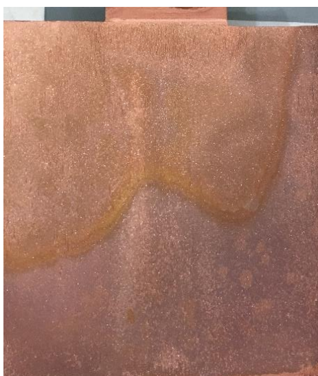
Рис. 5. Катод, при получении которого концентрация тиомочевина в электролите составляла 3,6 \cdot 10^{-3} \text{ г/дм}^3
