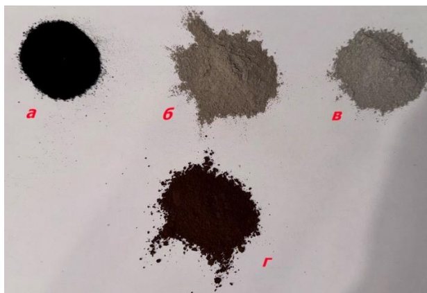
Рис. 1. Порошки-компоненты противопопригарных покрытий: а – сухой углеродистый остаток; б – шамотный мертель; в – синтетический ангидрит; г – «Литоформ»
