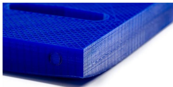
Рис. 6. Закручивание нижнего угла модели [3]
