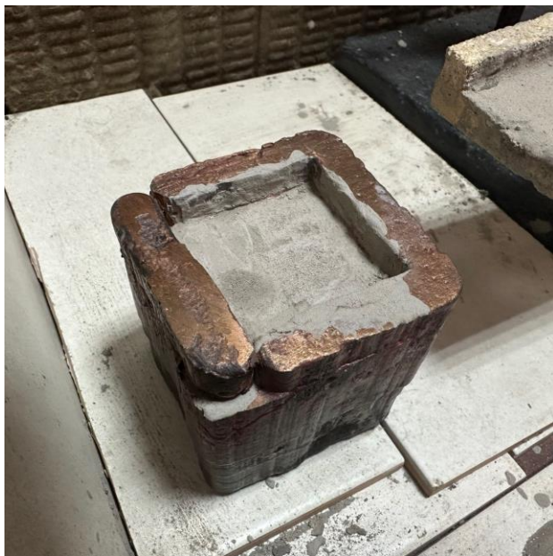
Рис. 2. Лабораторная изложница, обработанная пульпой шамотного мертеля с помощью кисти
