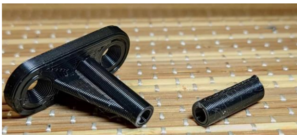
Рис. 2. Характерная картина разрушения детали, напечатанной из PLA [2]
