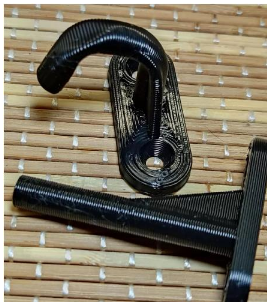
Рис. 3. Деформация детали, напечатанной из PLA пластика под воздействием нагрева [2]
