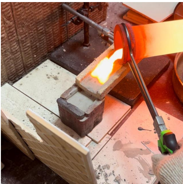
Рис. 3. Процесс отливки лабораторных медных пластин (анодов)
