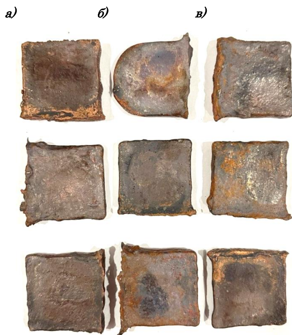
Рис. 5. Шамотный мертель: а – 1,0 мм; б – 0,5 мм; в – 0,1 мм (вариант №1)
