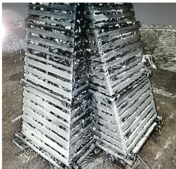
Рис. 11. Фрагмент 3D-модели Маяка с погрешностью перекрытий облаков точек до 1,8 мм
