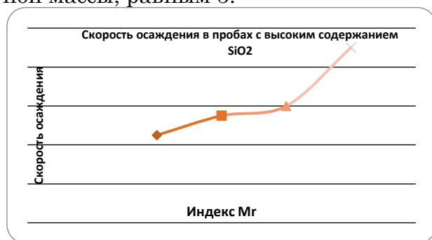
Рис. 2. Скорость осаждения в пробах с высоким содержанием SiO_2 , в зависимости от индекса молярной массы флокулянта
