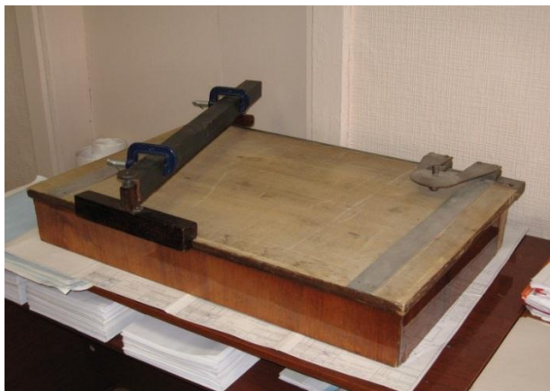
Рис. 4. Прибор академика В.А. Желиговского для определения коэффициента трения движения
