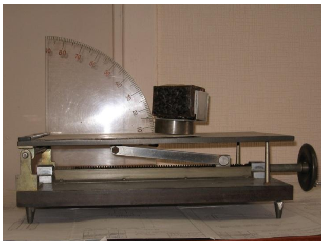
Рис. 3. Прибор для определения коэффициента трения покоя методом наклонной плоскости
