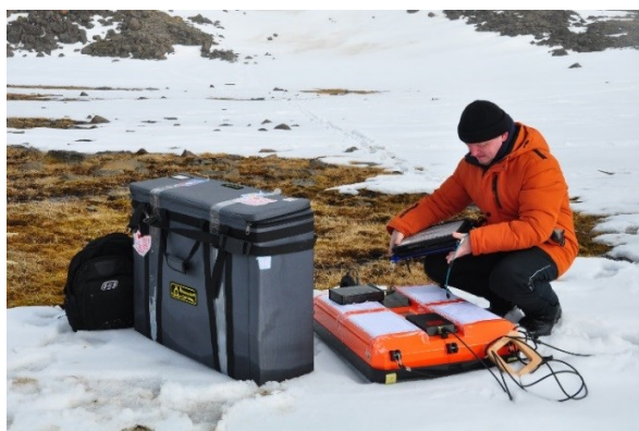
Рис. 14. Настройка аппаратуры георадара для исследования в Бухте Тихая (о. Гукера).
