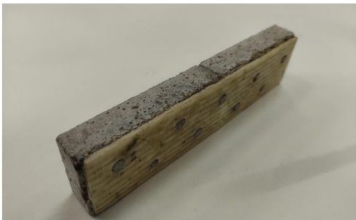
Рис. 2. Однослойная и двухслойная сборная балочки после испытания: а – вид однослойной балочки с образованной поперечной трещиной; б – вид полимеркомпозитной пластины без трещины сборной балочки
