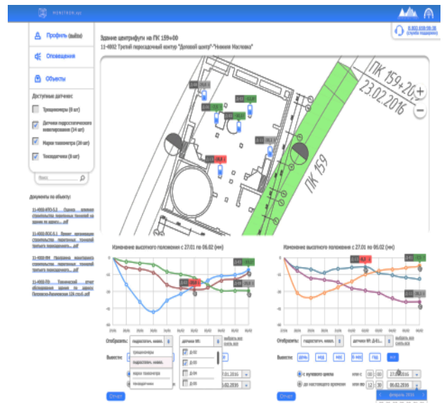
Рис. 7. Отображение информации по высотному положению фундамента через сеть Интернет в программном комплексе «Monitron.kyuz»
