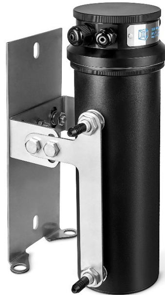
Рис. 6. Датчики гидростатического нивелирования, установленные на фундаменте центрифуги
