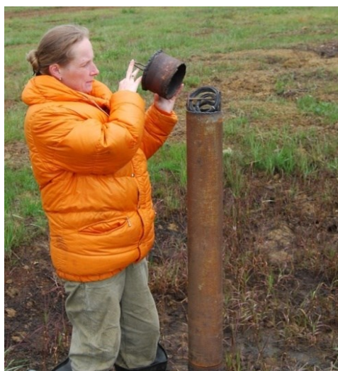
Рис. 4. Термометрическая скважина на площадке фонового мониторинга, Чукотка
