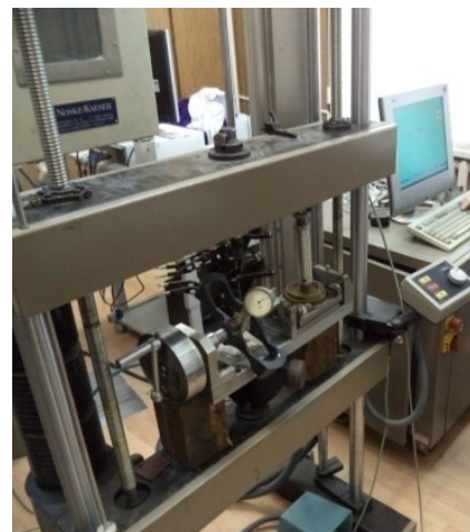
Рис. 5. а – зависимость \tau_{длит} = f(\sigma) б – сдвиговой прибор ВСВ-25м, оснащенный устройством для автоматического нагружения, измерений и обработки данных от универсальной установки UTS-10
