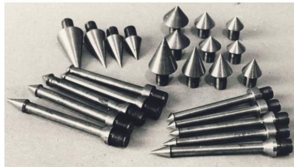
Рис. 1. Конические зонды различного типоразмера
