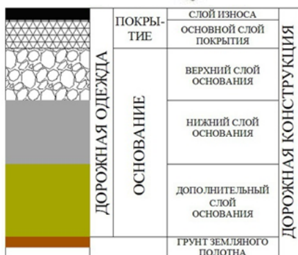
Рис. 1. Схема дорожной одежды
