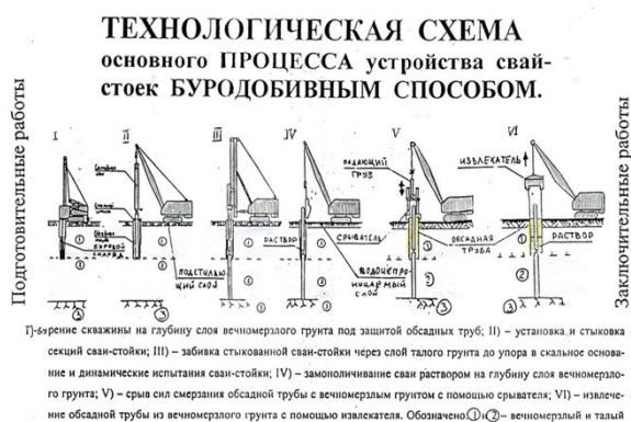
Рис. 7. Буродобивной способ
