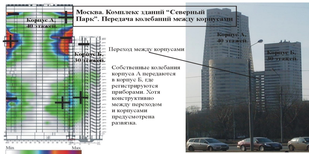
Рис. 4. Проверка эффективности развязки здания
