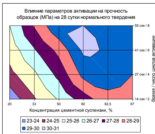
Рис. 3. Зависимость прочности мелкозернистого бетона от параметров активации
