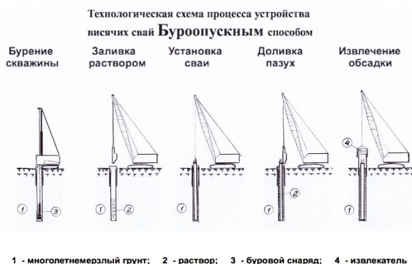
Рис. 4. Буроопускной способ
