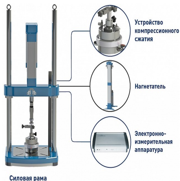
Рис. 9. Состав установки компрессионно-фильтрационных испытаний
