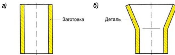
Рис. 6.1. Заготовка (а) и деталь, полученная в результате операции раздачи (б)
