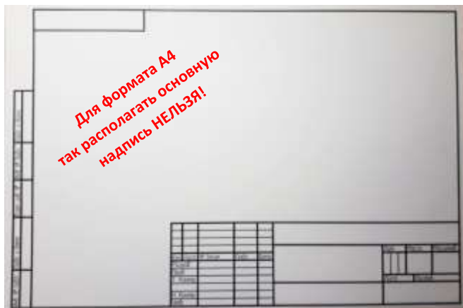
Рис. 3. Неверное расположение основной надписи для формата А4
