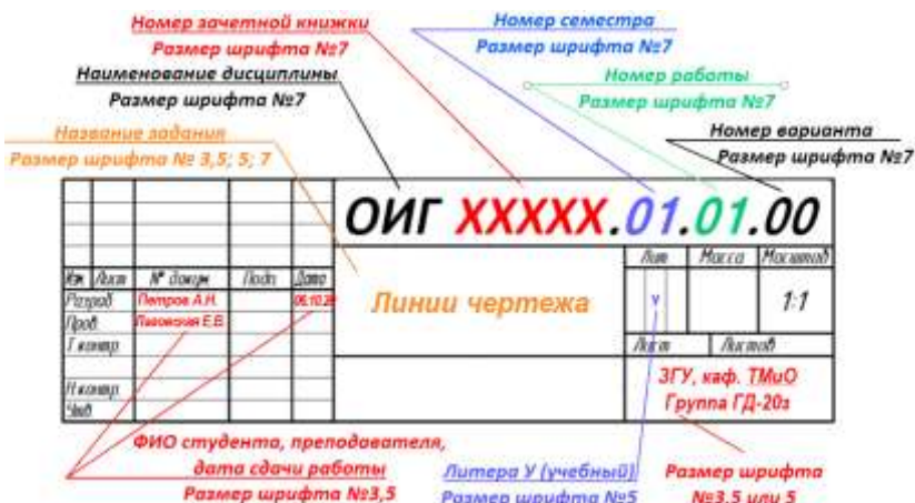
Рис. 7. Заполнение основной надписи
