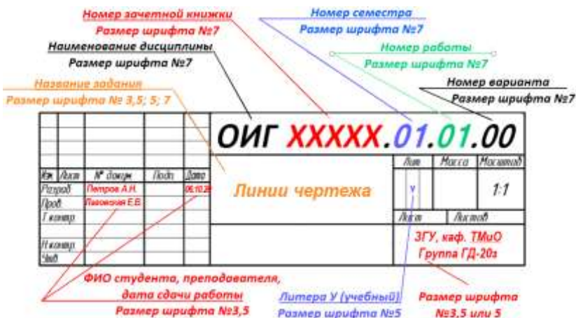
Рис. 7. Заполнение основной надписи
