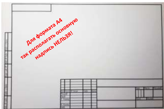
Рис. 3. Неверное расположение основной надписи для формата А4
