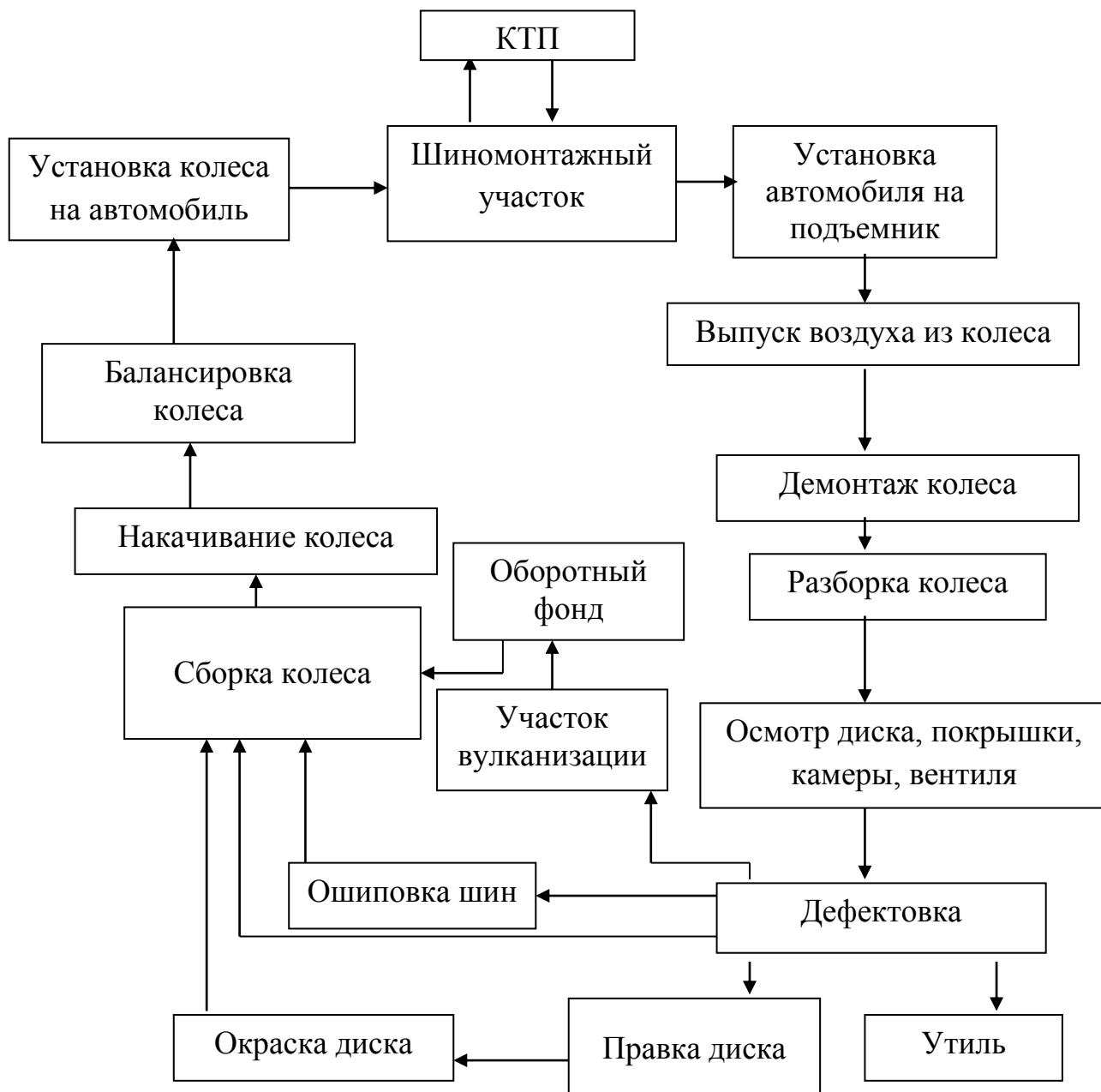
Рисунок 3.7 - Схема технологического процесса шиномонтажных работ
