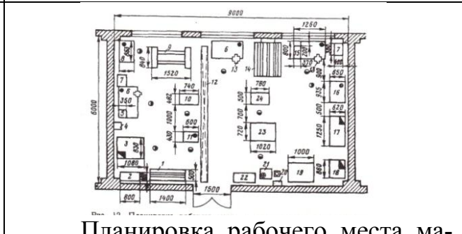
Планировка рабочего места маляра
