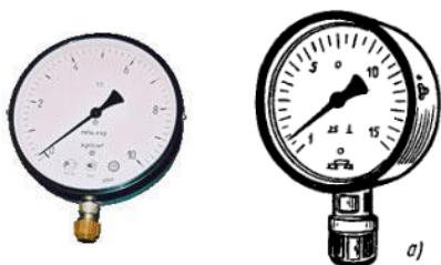
Рисунок 1 – Пружинный манометр типа ОБМ
