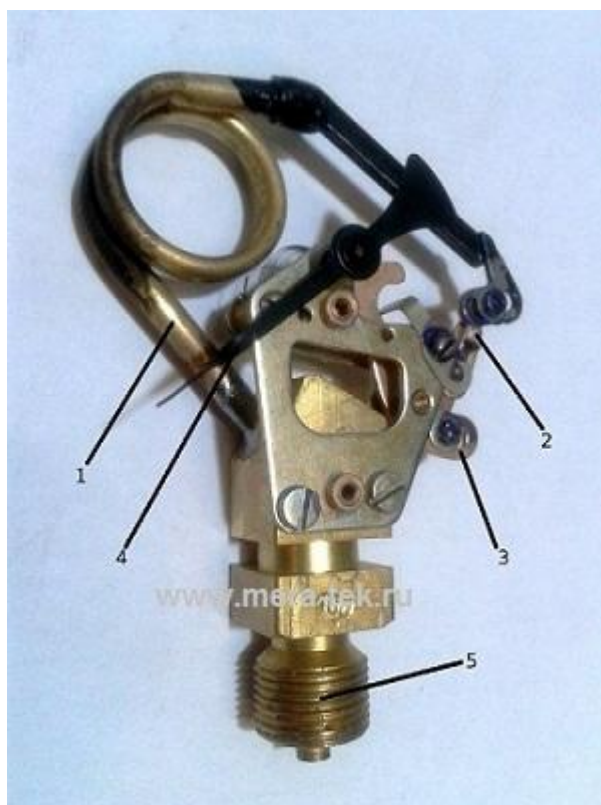
Рисунок 2 - Схема устройства манометра с трубкой Бурдона 1-трубка Бурдона, 2-тяга передаточного механизма, 3-зубчатый сектор, 4-стрелка, 5-штуцер
