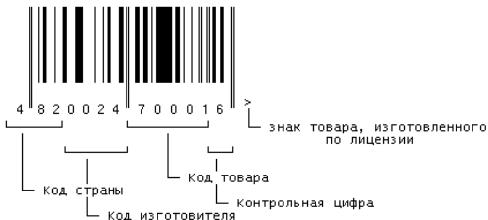
Рисунок 3 - Пример расшифровки штрих-кода EAN-13
