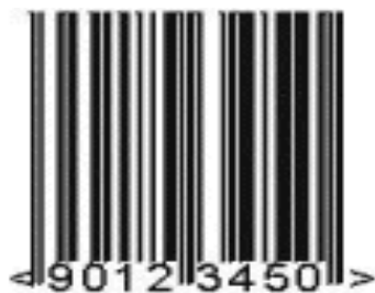
Рисунок 4 - Пример кода линейной символики EAN-8
