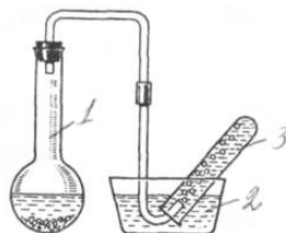
Рисунок 1 Собираение газа над водой
