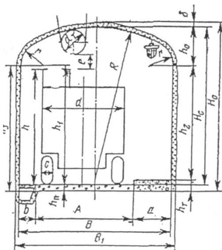
Рисунок 5.1 - Сечение транспортной выработки прямоугольносводчатой формы при безрельсовом транспорте с набрызгбетонной крепью
