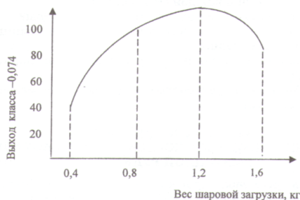
Рис. 5.5. Зависимость крупности измельчения от степени заполнения мельницы шарами
