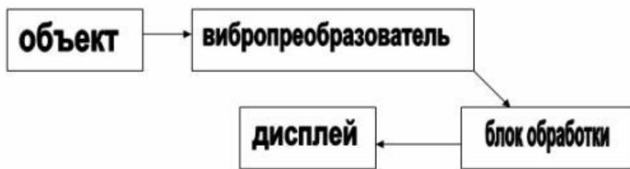
Рис.3 Структурная схема процесса измерения вибрации (в общем случае)
