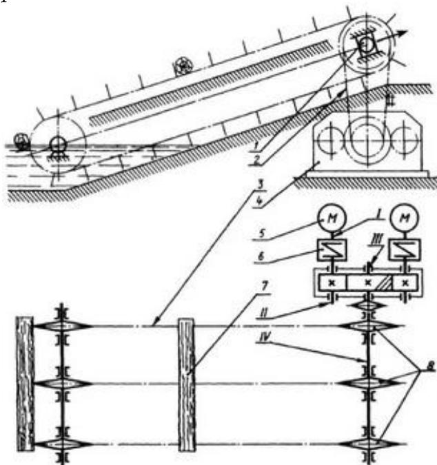
**Рис. 1. Кинематическая схема привода к лесотаске: 1 - натяжное устройство; 2 - цепная передача; 3 - тяговая цепь; 4 - цилиндрический редуктор; 5 - двигатель; 6 - упругая муфта со звездочкой; 7 - бревно; 8 - звездочки тяговой цепи; I, II, III, IV - валы двигателя, быстроходный и тихоходный редуктора, рабочей машины**
