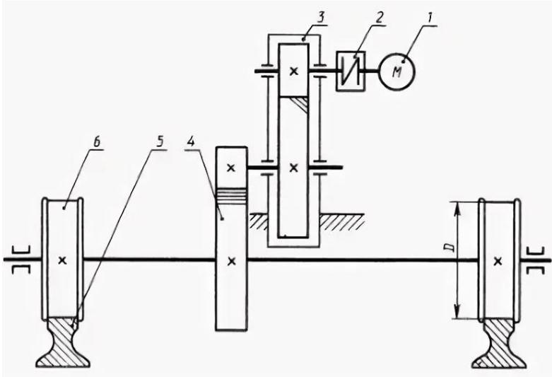
**Рис. 1. Кинематическая схема привода механизма передвижения мостового крана: 1 – двигатель; 2 – упругая втулочная-пальцевая муфта; 3 – цилиндрический редуктор; 4 – цилиндрическая зубчатая передача; 5 – рельс; 6 – колеса; I, II, III, IV – валы двигателя, быстроходный и тихоходный редуктора, рабочей машины**
