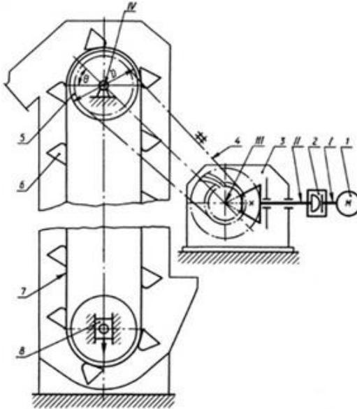
**Рис. 1. Кинематическая схема привода ковшового элеватора: 1 – двигатель; 2 – цепная муфта; 3 – конический редуктор; 4 – цепная передача; 5 – барабан; 6 – ковш; 7 – лента элеватора; 8 – натяжное устройство; I, II, III, IV – валы двигателя, быстроходный и тихоходный редуктора, рабочей машины**
