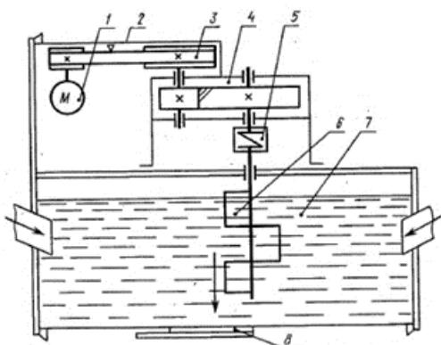
Рис. 1. Кинематическая схема привода к мешалке:
