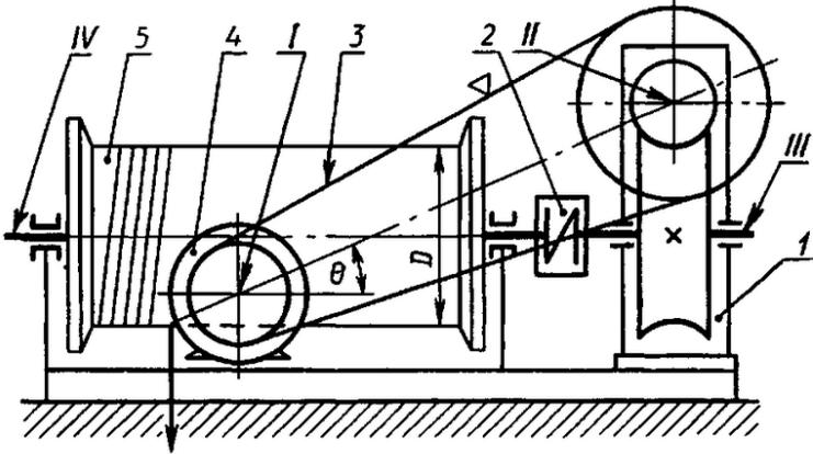
Рис. 1. Кинематическая схема привода электрической лебедки:
