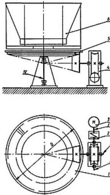
**Рис. 1. Кинематическая схема привода к тарельчатому питателю для формовочной земли: 1 – коническая зубчатая передача; 2 – упругая муфта со звездочкой; 3 – двигатель; 4 – червячный редуктор; 5 – диск питателя; 6 – загрузочный бункер; I, II, III, IV – валы двигателя, быстроходный и тихоходный редуктора, рабочей машины**
