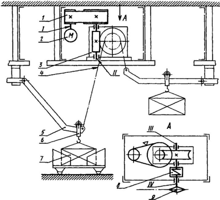
Рис. 1. Кинематическая схема привода к качающемуся подъемнику:
