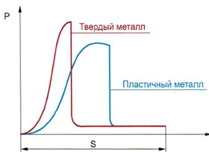
Рис. 2.5. Характер изменения силы выруб-ки по перемещению пуансона при оптимальном зазоре Z
