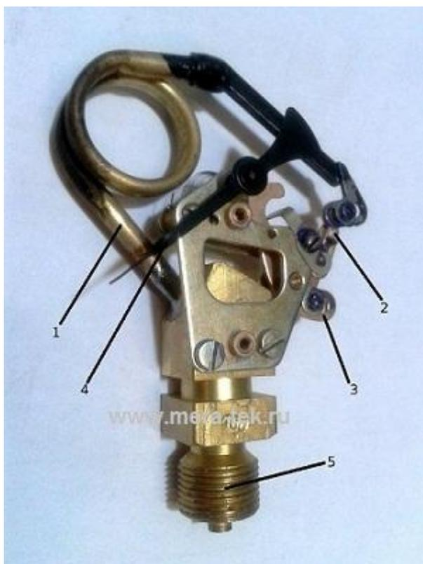
Рисунок 2 - Схема устройства манометра с трубкой Бурдона
